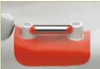
仅使用成型树脂收缩量会很大， 建议中间用塑料棒连接
