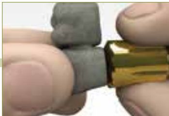
用扩孔器将锁扣式可铸基底形成的唇边去除。
