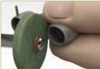
用橡胶轮打磨多余边缘
